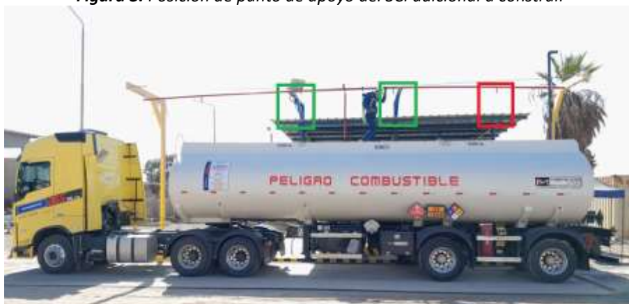
Figura 3. Posición de punto de apoyo del SCI adicional a construir
